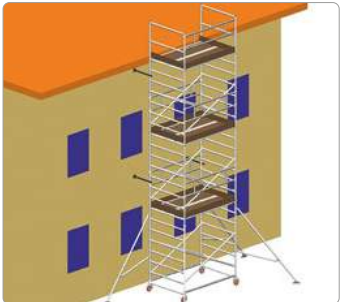
Andamio anclado a pared.
